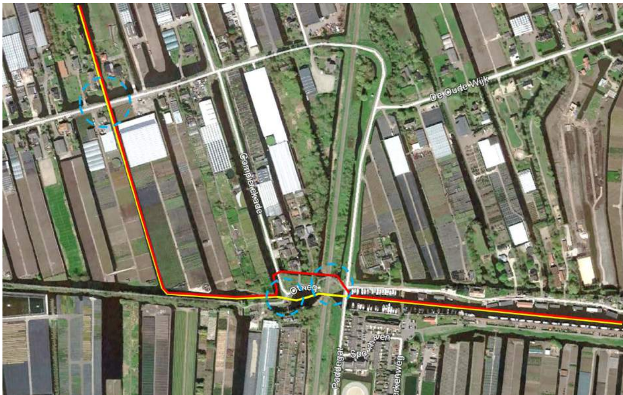
Figuur 36: Detail van het tracé Klein Giethoorn - Gouwe. Optimalisaties: 1. verhogen van de diiker in plaats van het inpassen van middelgrote brug in de kruising met de Loeteweg. 2. ter hoogte van de kruising met de Compierekade en de spoorlijn kan beter worden gekozen voor een systeem met overtoom en het verhogen van de spoorbrug en de Paddegatbrug (gele route), in plaats van een ondertoom, perceelbruggen en overtoom (rode route).
